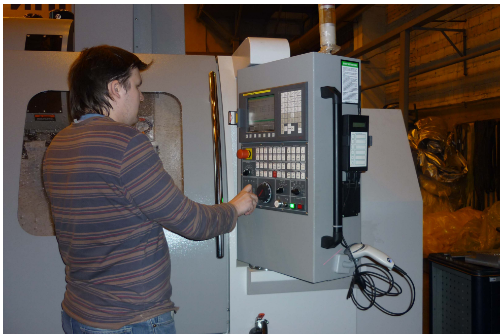
Рис. 17.1. Электронный блок мониторинга на станке Leadwell
