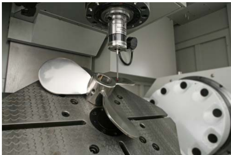
Рис. 15.9. Измерительный щуп касается поверхности детали
