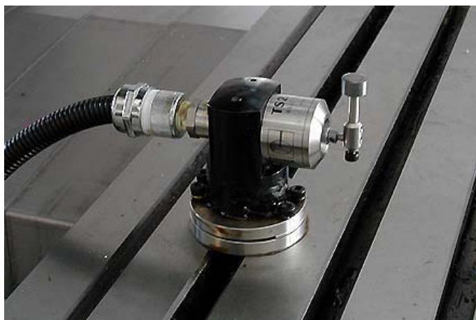
Рис. 15.7. Датчик Renishaw TS-27 для измерения длины и радиуса инструмента. Преимущества автоматического измерения – высокая точность и скорость
