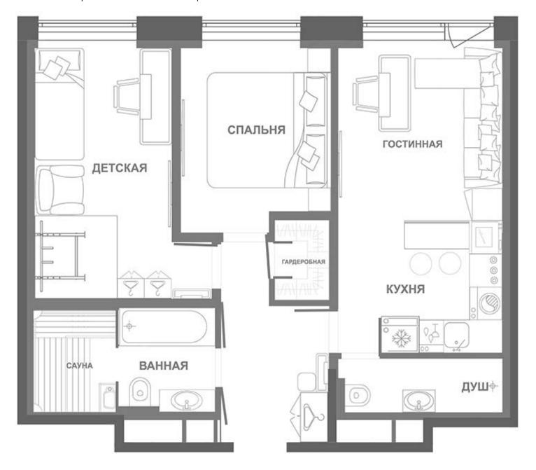
Высота потолков - в чистоте 3150. Пирог пола 170, пирог потолка 300 (первый уровень 150 - звукоизоляция, второй 150 - подсветка, вентиляция) Высота окон - 2250, от пола 400. Высота потолков в комнатах (включая кухню) — 2680. Пирог потолка в прихожей, санузлах 550 (первый уровень 150 - звукоизоляция, второй 430 - подсветка, оборудование вентиляции). Высота потолков в прихожей, санузлах - 2400
